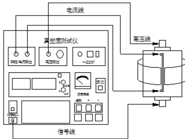
图 (b) 可拆式线圈测量接线图
