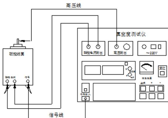
图 (a) 固定式线圈测量的接线图
